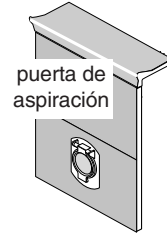
Figura 15: Puerta de aspiración dedicada típica
