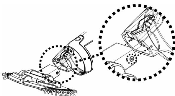
**NOTA:** Para sustituir los cepillos del cabezal de succión, levante el extremo y tire de él para dejar espacio para uno nuevo.
