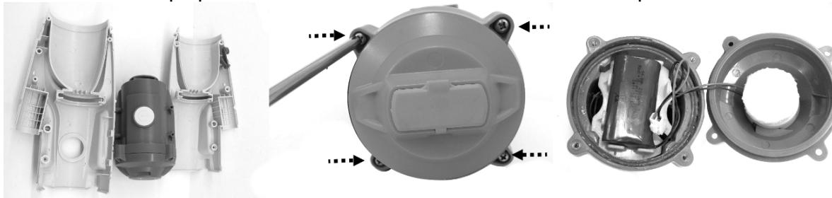
4. Retirer le pack de batterie du compartiment principal. Pour détacher le pack de batterie, appuyer sur le clip du connecteur et tirer le fil. NOTICE: Emballer immédiatement le connecteur avec de l'isolant afin d'éviter un court circuit si les deux bouts de fils se touchent.
