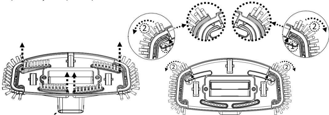
**¡ATENCIÓN!** En el caso de piscinas revestidas de vinilo o piscinas de fibra de vidrio, se recomienda mantener los cepillos en el cabezal de succión para evitar dañar la piscina.
