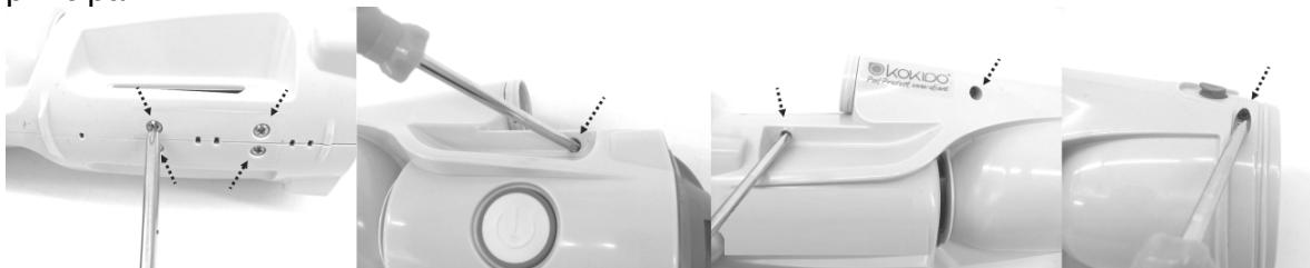
3. Séparer le corps en deux moitiés afin d'accéder au compartiment principal. Utiliser un tournevis Philips pour retirer le couvercle arrière et accéder au pack de batteries.
