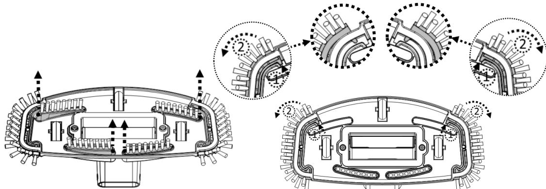
**AVERTISSEMENT !** Pour les piscines en fibre de verre et avec une doublure en vinyle, il est recommandé de laisser les brosses sur la tête d'aspiration afin d'éviter d'endommager la piscine.
